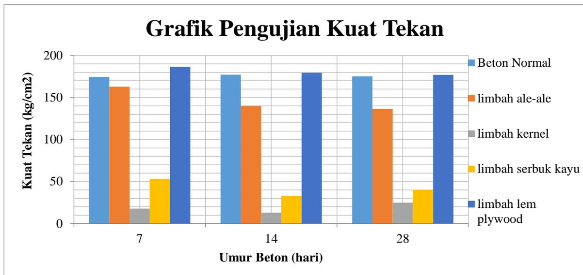
Gambar 4. Grafik Pengujian Kuat Tekan Beton
