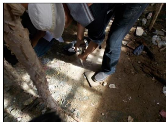
Gambar 8. Uji Hammer Test Pelat Lantai
