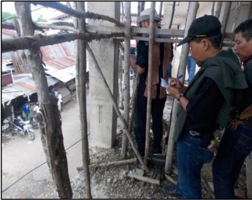
Gambar 9. Uji Hammer Test Kolom
