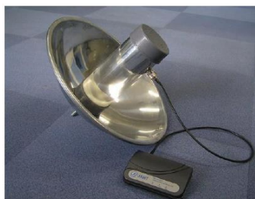
Gambar 3. Antena Wajan Bolic yang sudah dirakit
