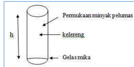
Gambar 1. Simulasi Pengukuran kekentalan minyak pelumas.
