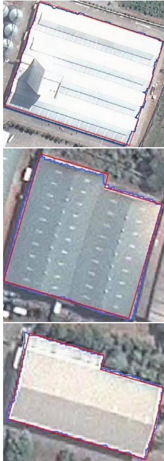
Gambar 8. Perbedaan Bentuk Vektor Hasil Ekstraksi Otomatis dan Ekstraksi Manual Dari Tutupan Lahan Bangunan
