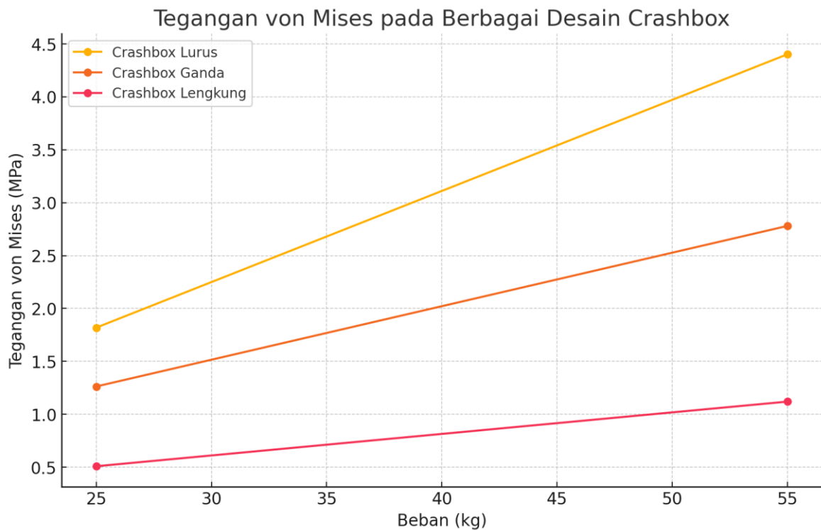
Gambar 11 Grafik Tegangan Von Mises pada Berbagai Desain Crashbox
