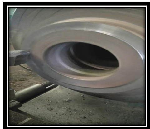
Gambar 4.5.15 Bubut Diameter Permukaan.
