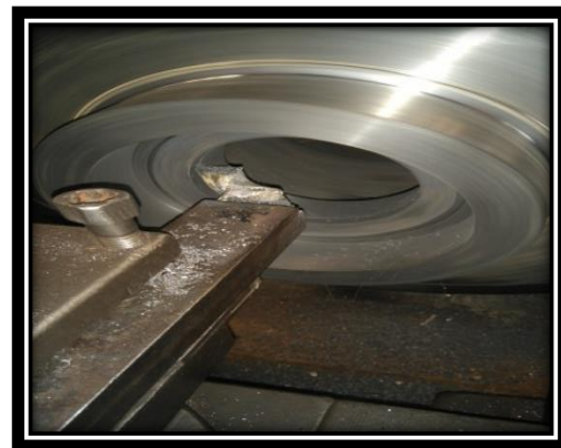
Gambar 4.5.20 Bubut Diameter Bertingkat.
