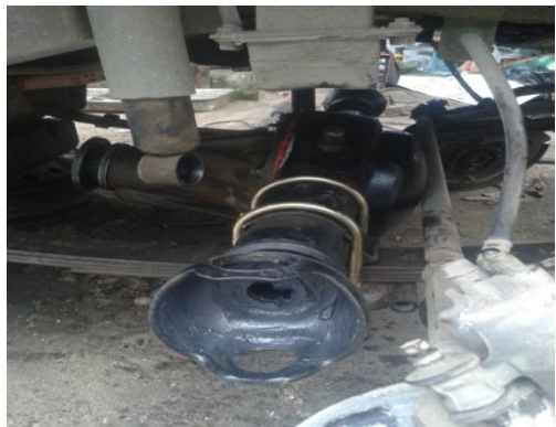
Gambar 21. Pemasangan baut U
