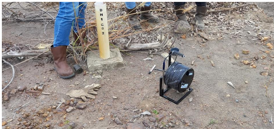
Gambar 5 Lokasi Pengamatan Lubang Bor DH1C02 dan alat water level meter
