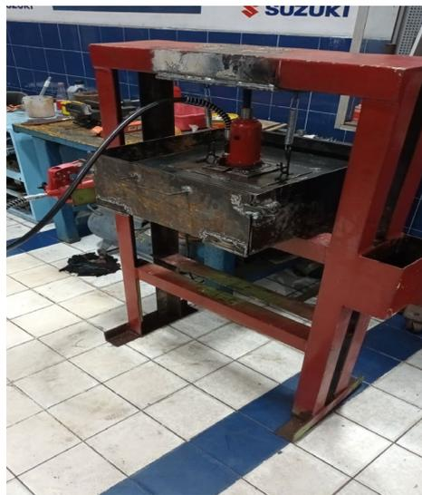
Gambar 6. Mesin Press 2 ton manual hasil buatan tim abdimas Poliban
