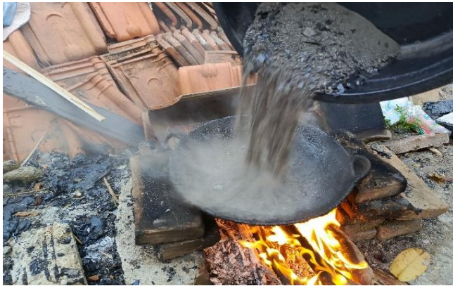
Gambar 7. Pasir Dan Cacahan Plastik PET Dimasukkan ke dalam Wajan
