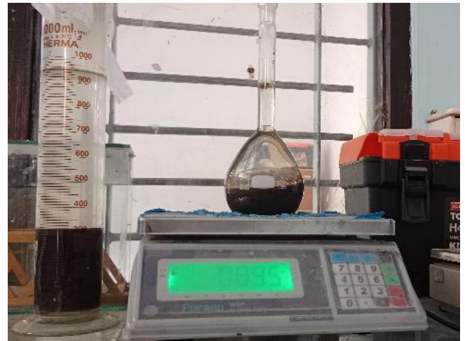
Gambar 13. Pemeriksaan Kadar Lumpur Dengan Gelas Ukur
