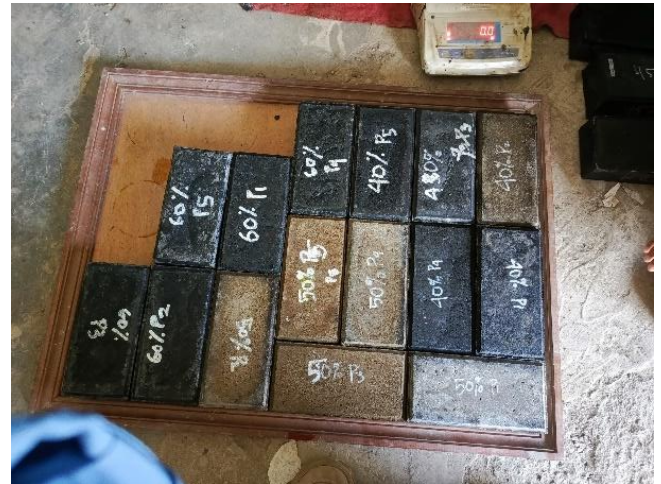
Gambar 9. Pengeringan Benda Uji Paving Block Inovasi Pada Suhu Ruang
