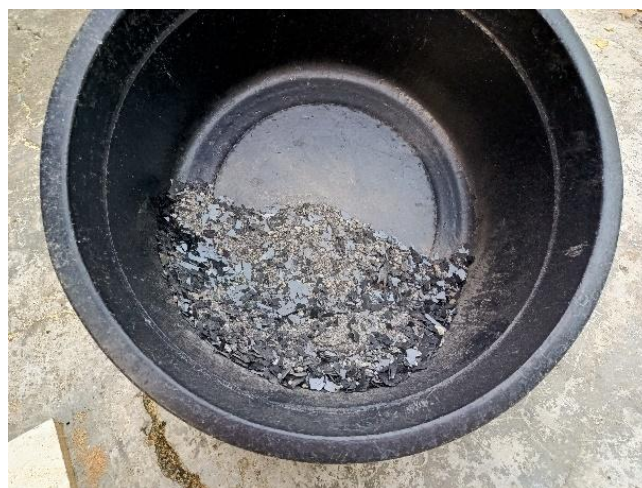
Gambar 6. Pencampuran Pasir Dan Cacahan Plastik PET
