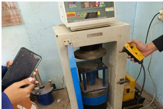
Gambar 10. Pengujian Paving Block Menggunakan Digital Compression Machine
