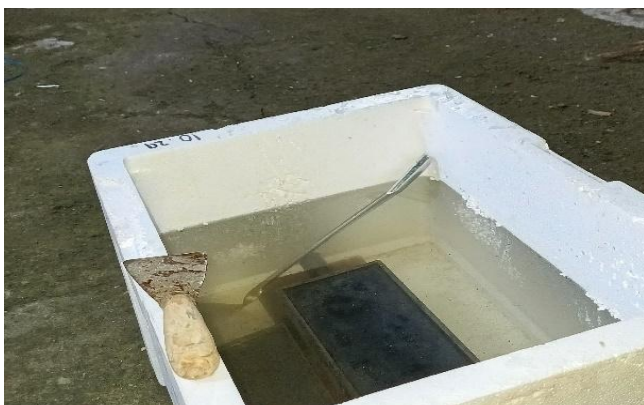
Gambar 8. Paving Block Yang Telah Di Cetak Di Masukkan Kedalam Bak Air
