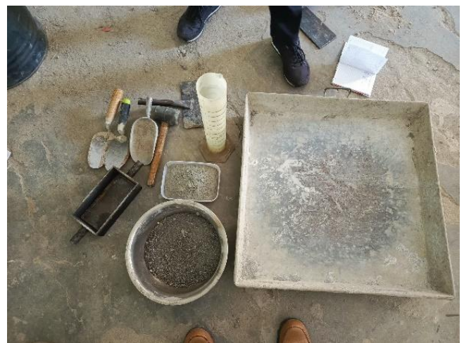
Gambar 4. Persiapan Alat Dan Bahan Pembuatan Paving Block Normal
