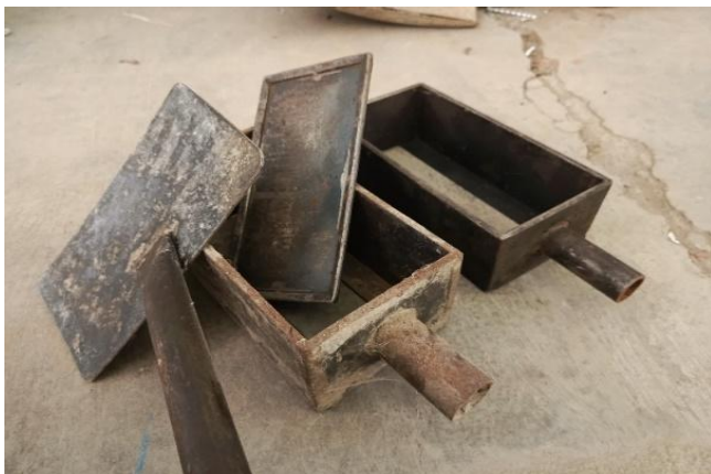
Gambar 2. Cetakan Paving Block
