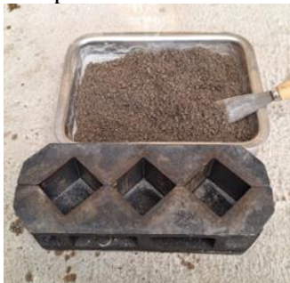
Gambar 2. Bekisting Mortar dan Hasil Adukan
