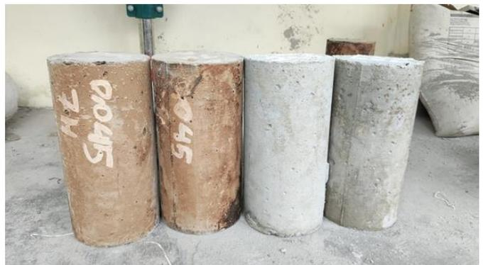
**Gambar 8** Perbandingan Benda Uji yang Direndam Dalam Air Gambut dan Air Aquades
