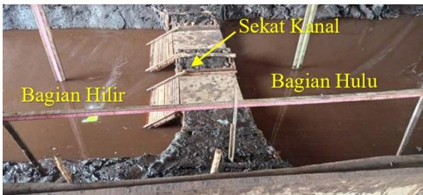
**Gambar 11.** Keadaan saat dilakukan pengujian rembesan (Sumber: Hasil dokumentasi lapangan)
