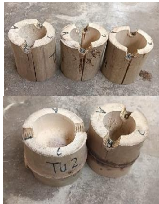
Gambar 8. Dokumentasi kerusakan pada specimen uji kekuatan tumpu
