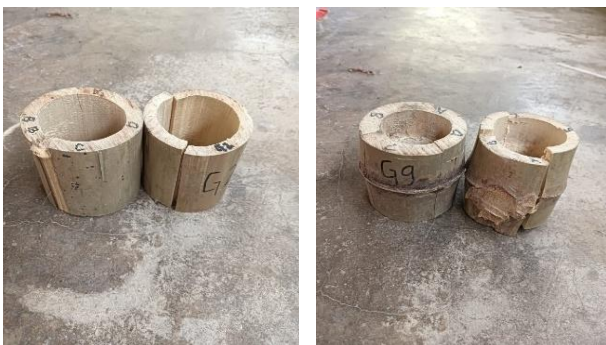
Gambar 6. Bentuk kerusakan pada spesimen uji kuat geser
