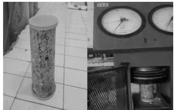
Gambar 11. Pengujian sampel Core Drill dengan compression test
