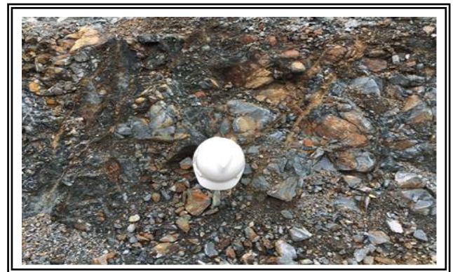
Gambar 11 Kondisi galian andesit lapuk di area saddle dam pada Sta 5 di elevasi 146.59
