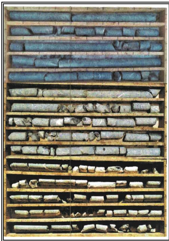
Gambar 14. Susunan coring area saddledam hasil Pemboran Pilot Hole
