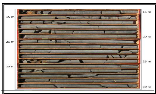
Gambar 20 Hasil sampel coring pada titik bor BH.14-3 pada kedalaman 14.00 - 30.00 m.
