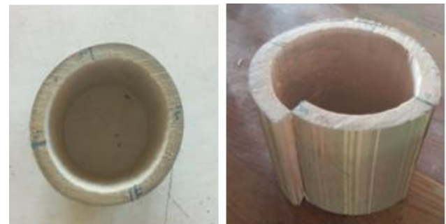
Gambar 5. Bentuk kerusakan benda uji pada pengujian kuat geser
