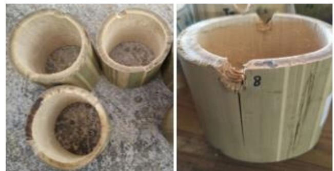
Gambar 6. Bentuk kerusakan benda uji pada pengujian kuat tumpu
