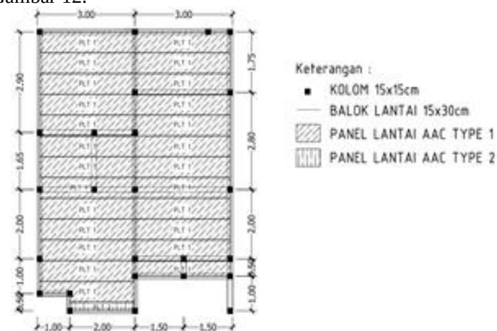
Gambar 12. Denah Rencana Lantai Panel AAC
