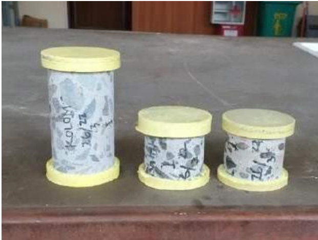
Gambar 5. Penimbangan dan pengujian kuat tekan benda uji dari hasil Core Drill
