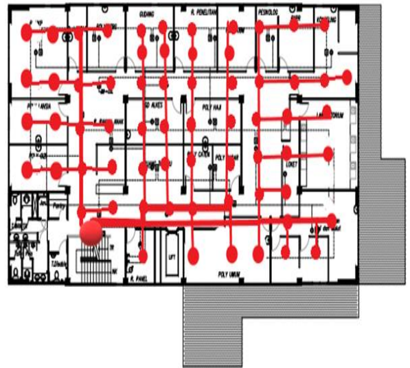
Gambar 4. Titik lokasi dan jumlah sprinkler pada lantai 2
