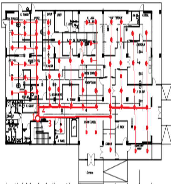
Gambar 3. Titik lokasi dan jumlah sprinkler pada lantai 1
