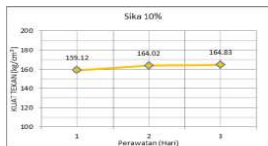
Gambar 6. Grafik Nilai Kuat Tekan Mortar dengan Penambahan 10% Sic Bonding Adhesive
