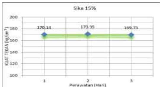
Gambar 7. Grafik Nilai Kuat Tekan Mortar dengan Penambahan 15% Sic Bonding Adhesive
