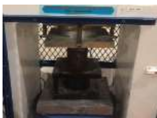
Gambar 4. Pengujian Kuat Tekan dengan Digital Compression Strength Testing Machine 2000
