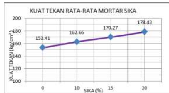
Gambar 9. Grafik Perbandingan Pengaruh Penambahan Zat Aditif Sic Bonding Adhesive Terhadap Nilai Kuat Tekan Mortar
