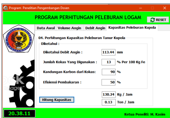
Gambar 14: Proses Perhitungan Kapasitas Peleburan Tanur Kupola
