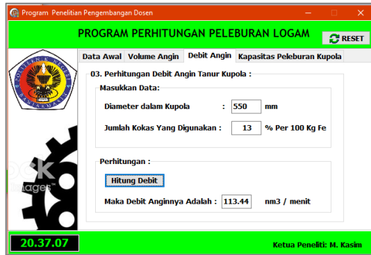
Gambar 12: Proses Perhitungan Debit Angin Yang Diperlukan
