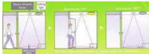
Gambar 2.17 cara kerja sensor PhilipWTKG 2310
