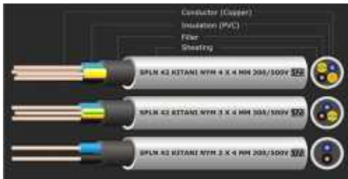
Gambar 2.13 Kabel tipe NYM
